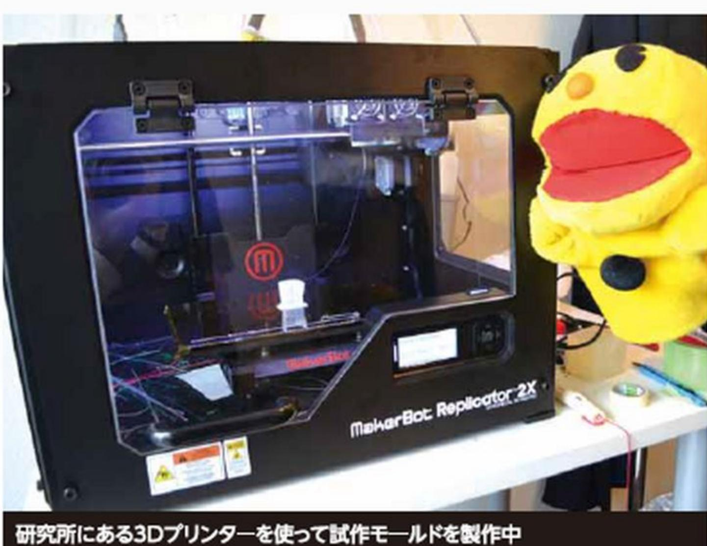
研究所にある3Dプリンターを使って試作モールドを製作中
